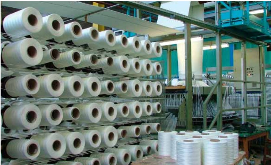
Webanlage zur Produktion des Tubetex - Liner DN 1000 mm.
